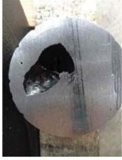
断熱押湯の切断面
