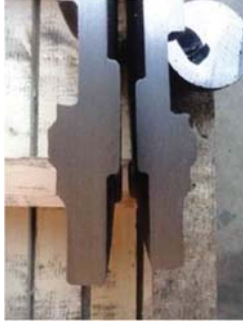
铸造品切断面(引け巣なし)
